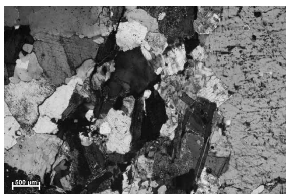
Slika 4.2. Mikrofotografija mikroskopskog preparata uzorka s lokaliteta Čarugin kamen. Vidljivi kvarc s kataklastičnim deformacijama, unduloznim potamnjenjem i šivanim rubovima, listići biotita i porfiroblast kalijskog feldspata.
