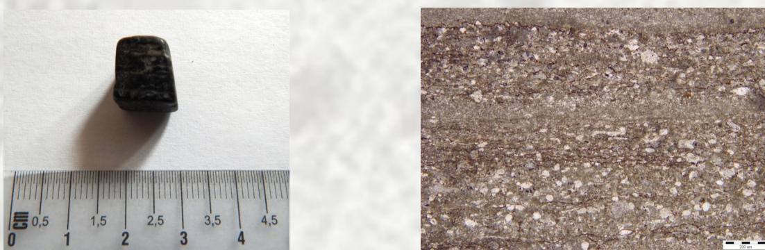
Sl. 5. Laminirani tamnosivi do crni bituminozni mikritni vapnenac: uzorak BT-1
