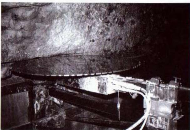
Sl. 5 Rezanje šlica za tlačni jastuk kod LNEC metode.
