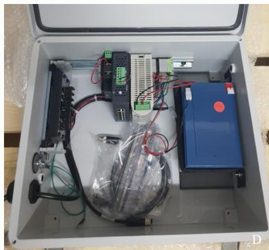
Dio novonabavljene opreme na projektu: A) Mobilni komplet za terenska mjerenja; B) Širokopolasni seizmometar; C) Akcelerograf ETNA2; D) Instalacijska kutija za akcelerografe s pratećim priborom.
