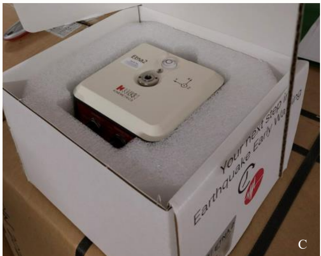
Dio novonabavljene opreme na projektu: A) Mobilni komplet za terenska mjerenja; B) Širokopolasni seizmometar; C) Akcelerograf ETNA2; D) Instalacijska kutija za akcelerografe s pratećim priborom.
