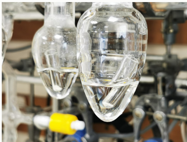
Uzorak jezerskog karbonata (bijeli sediment u manjoj staklenoj posudici) uronjen u fosfornu kiselinu (prozirna tekućina u većoj posudici). Prvo se vakuumom ukloni zaostali plin (zrak) koji predstavlja kontaminaciju, a zatim se provede reakcija karbonata s kiselinom, pri čemu se oslobađa plin \text{CO}_2 koji se želi analizirati
