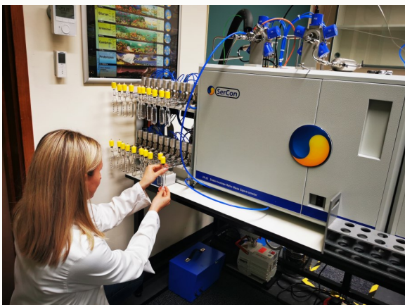
Priprema ekstrahiranog plina \text{CO}_2 za analizu na masenom spektrometru (IRMS)
