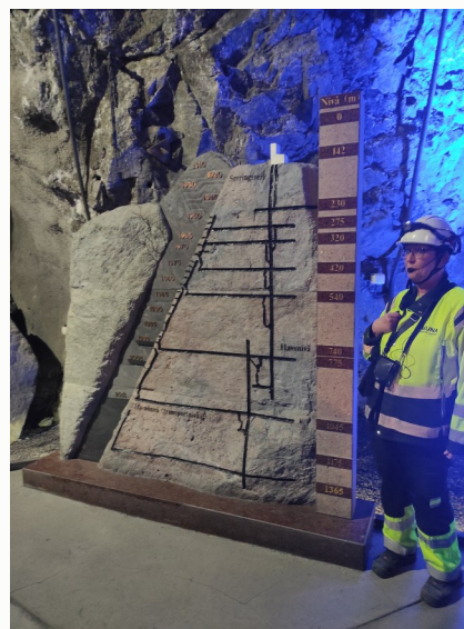
Voditeljica uz pomoć shematiziranog profila rudnika objašnjava kako je napredovala eksploatacija u rudniku Kiruna
