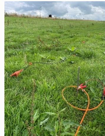
*Provodenje geofizičkih ispitivanja na nasipu Oostmolendijk u Nizozemskoj*
