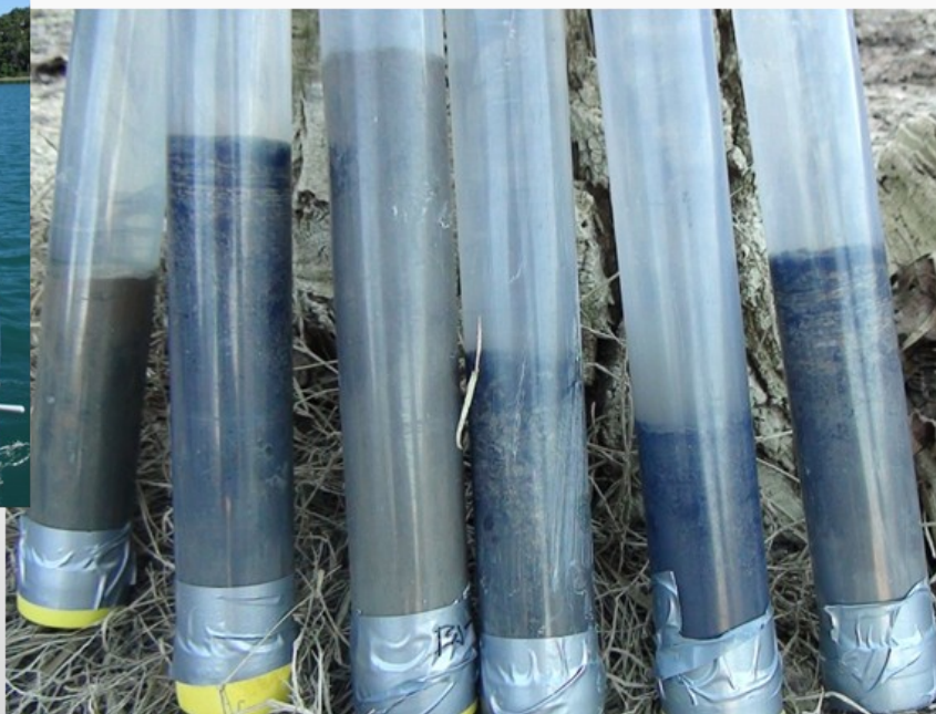
Slika 3. Gravitacijski korer za uzorkovanje kratkih jezgri (< 50 cm), izvađene jezgre sedimenata i laminirani sedimenti jezera Crniševo
