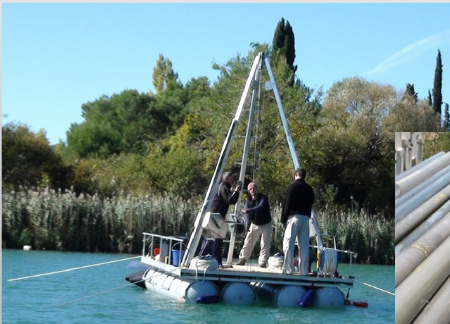
Slika 2. Istraživačka platforma Hrvatskog geološkog instituta na kojoj se nalazi klipni korer za uzorkovanje dugih jezgri (< 10 m)
