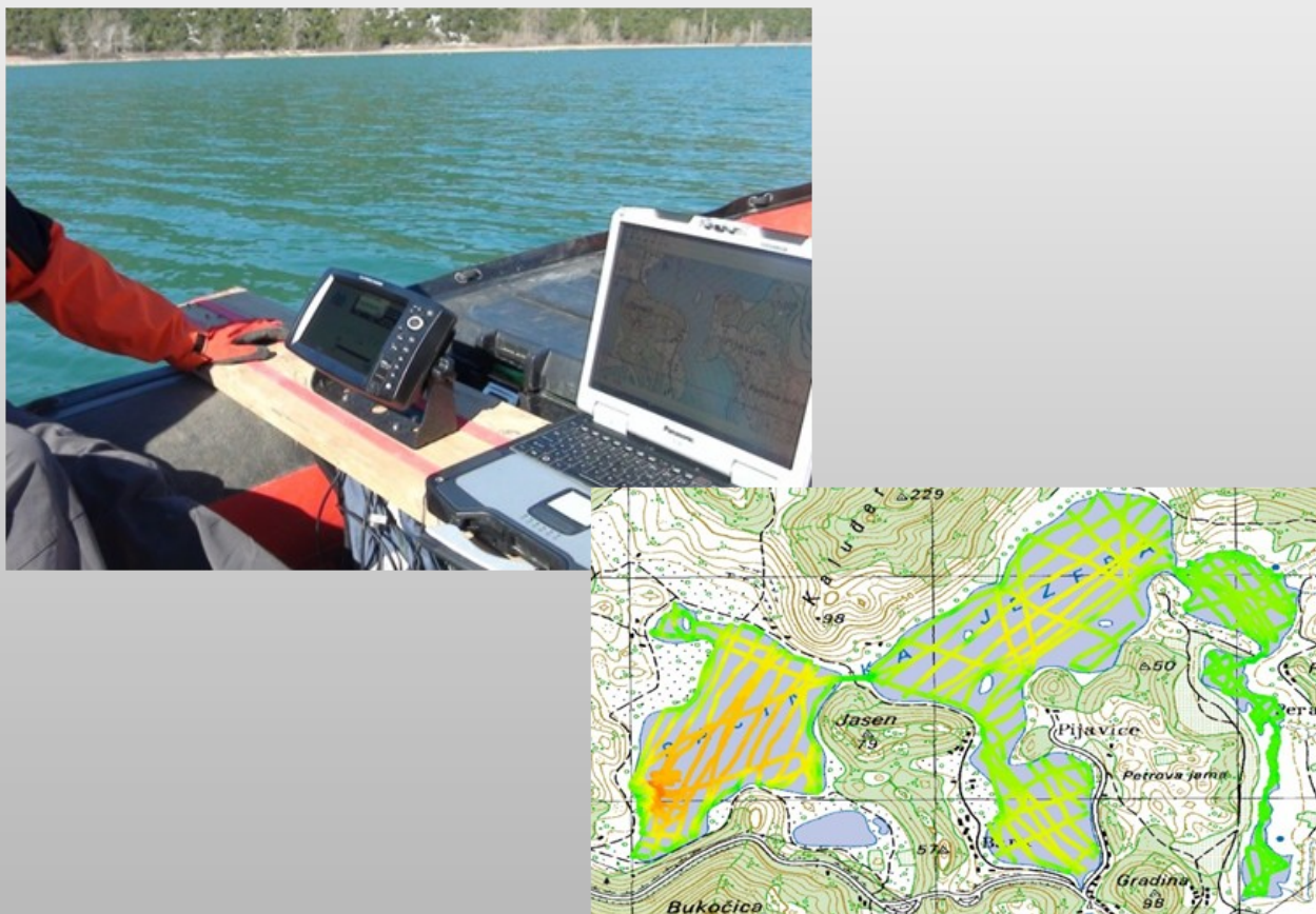
Slika 4. Snimanje jezerskog dna panoramskim dubinomjerom u Baćinskim jezerima i profili snimanja (zeleno-crveno je graduirani prikaz dubine)
