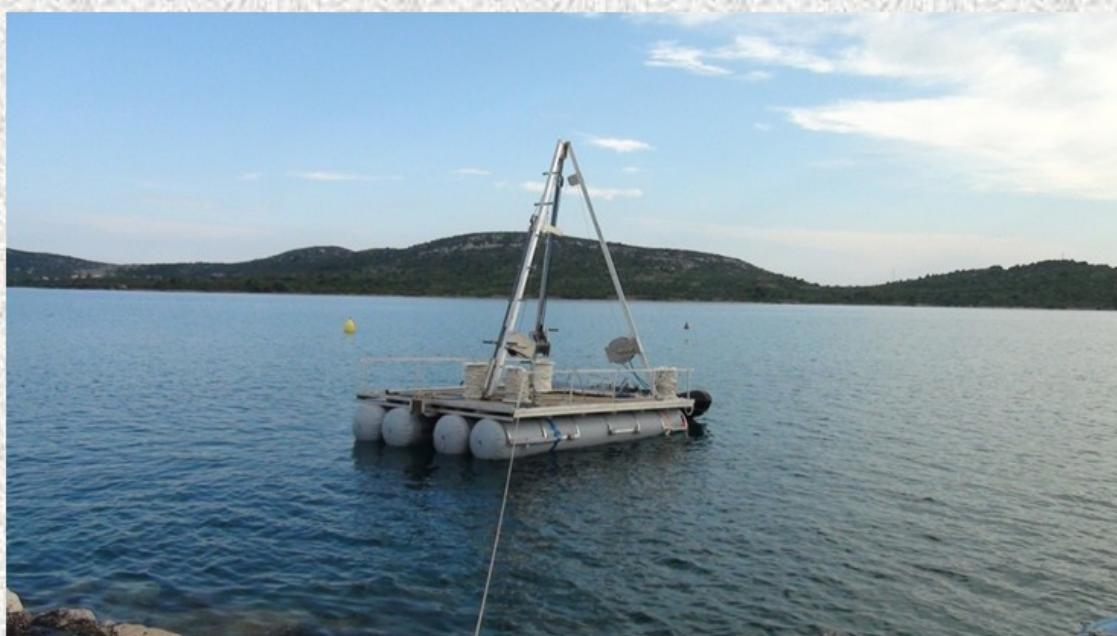
Sl. 1. Istraživačka platforma „Q2“ na koju je montiran klipni korer za vađenje neporemećenog sljeda sedimenta.
