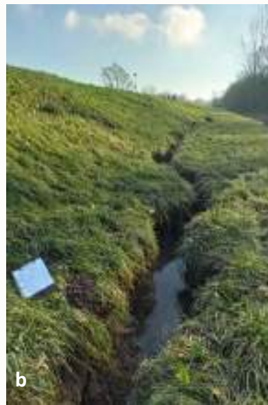
Slika 4: Primjeri pukotina u tlu nastalih uslijed bočnog širenja: a) na području Gline, b) na području Siska
