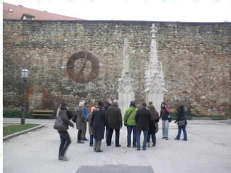
Slika 4. Kraj katedrale izloženi oštećeni baldahin s fijalama izrađen od litotamniskog vapnenca (lijevo) i obnovljeni od travertina (desno).
