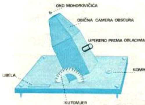
Mohorovičićev uređaj za mjerenje horizontalnog i vertikalnog gibanja oblaka kakav može izraditi svaki učenik.
